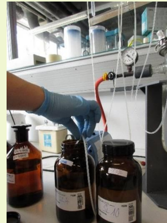
Pflanzenschutzmittel- und Biozidproduktwirkstoffe sind lichtempfindlich. Die Wasserproben werden daher von den Probennehmern in dunkle Glasbehälter gefüllt und lichtgeschützt transportiert.
